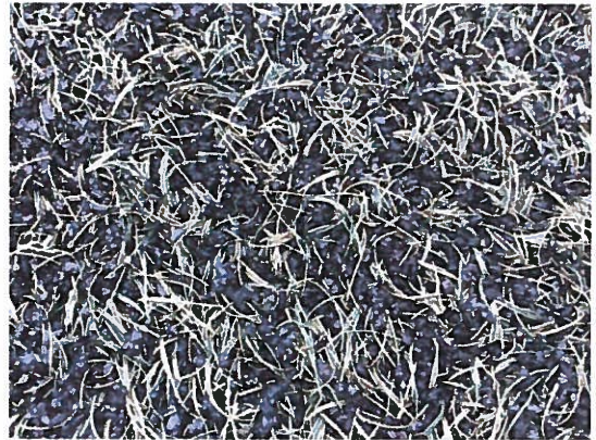
(afbeelding 2: sterk gespleten vezels)
