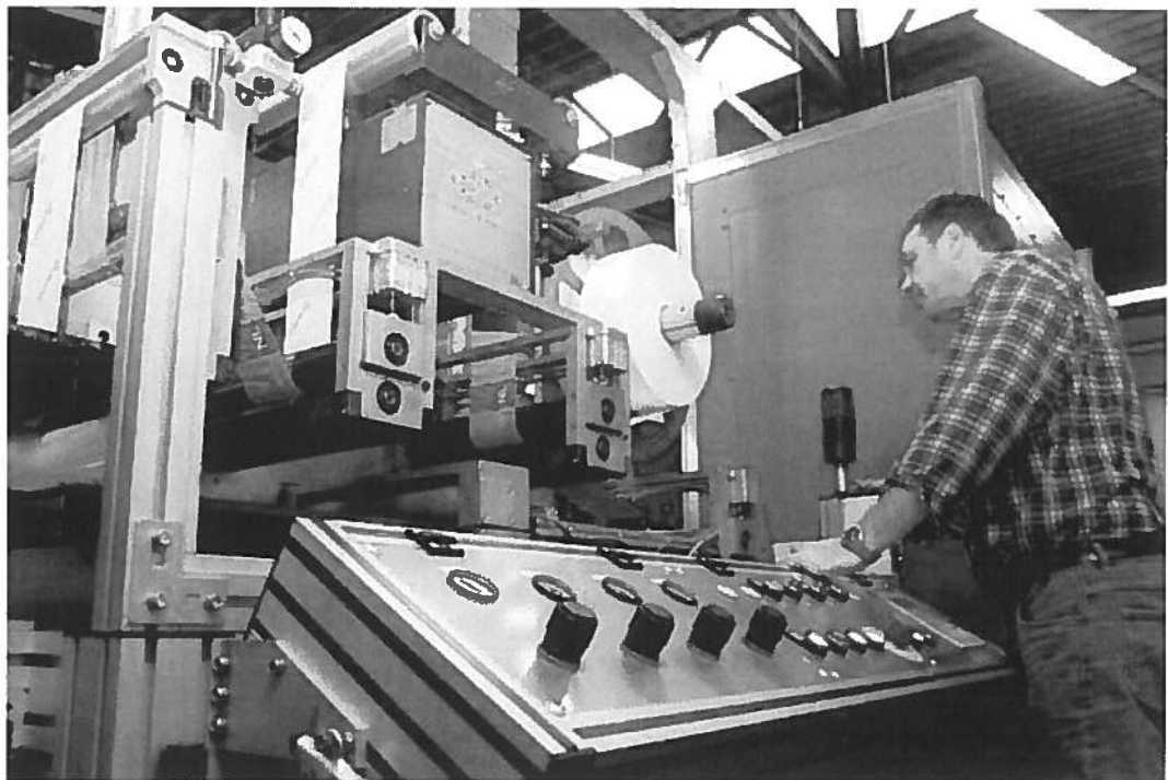
Folie wordt op het aluminium aangebracht
