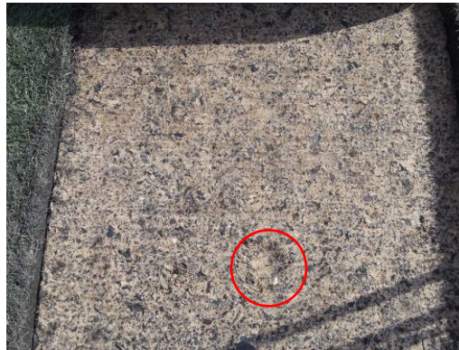
Impulsatorproef voorafgaand aan laagdiktebepaling en monsterneming
