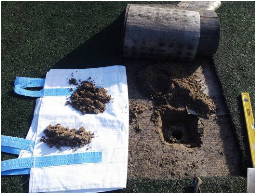
Opgegraven en opgeboord materiaal uit fundatie en onderbouw
