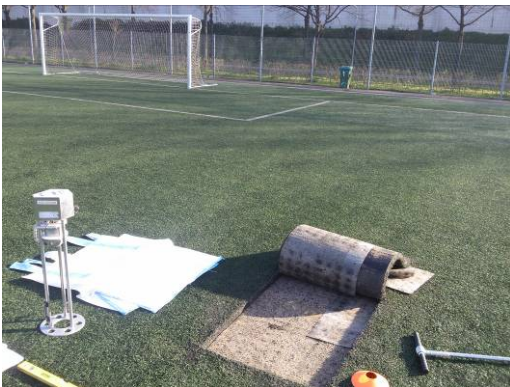
Toplaag opengesneden t.p.v. meetpunt 2
