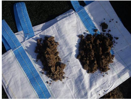
Opgegraven en opgeboord materiaal uit fundatie en onderbouw
