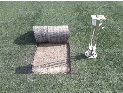
Impulsatorproef voorafgaand aan laagdiktebepaling en monsterneming
