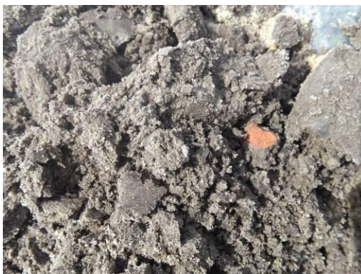
Stukjes puin in cunetbodem aangetroffen
