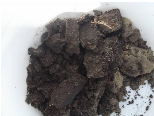
Cunetbodem hoofdzakelijk bestaande uit matig siltig, matig humeus en zwak kleilig fijn zand
