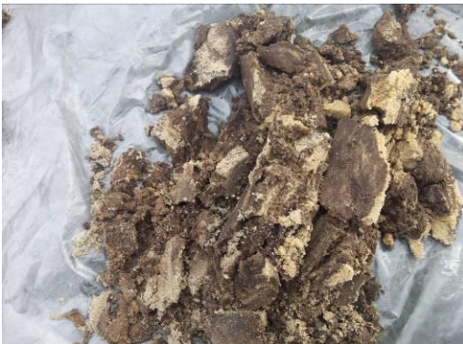
Cunetbodem hoofdzakelijk bestaande uit zwak siltig, zwak humeus fijn zand. Tevens hier en daar een kleilaaie
