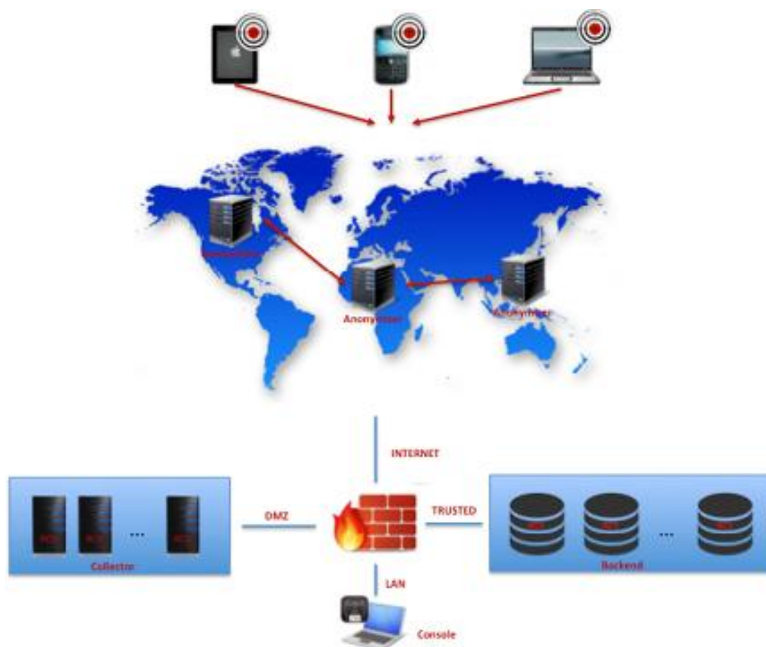
Figura 1 - Esquema de la arquitectura de RCS
