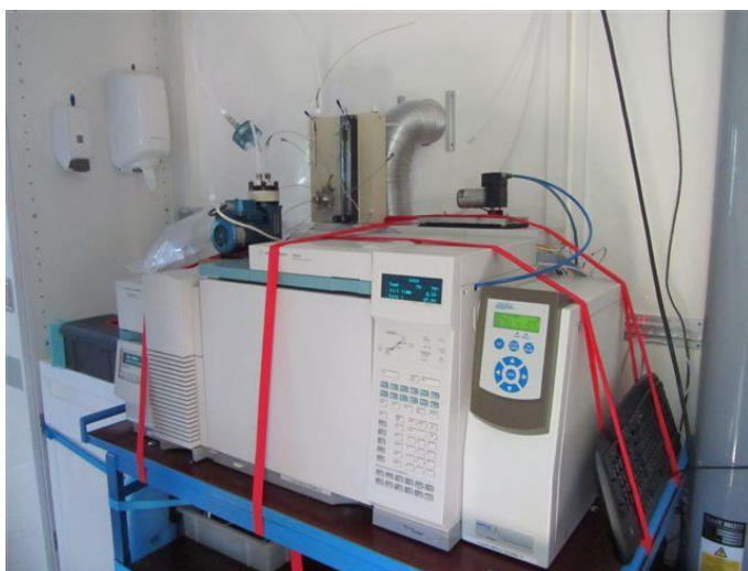
Foto 1: GC-MS in meetwagen omgevingslucht
