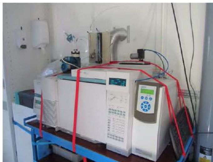
Foto 1: GC-MS in meetwagen omgevingslucht
