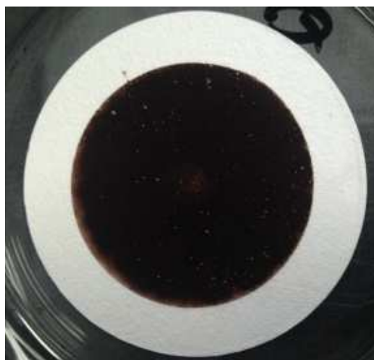
Filter(belading) E01-B, 6 uurs-meting, 28 januari 2016; zwart/donkerbruin gekleurde belading (door SGS, ter indicatie, de massa belading berekend op ca. 2,70 mg/Nm 3 ).
