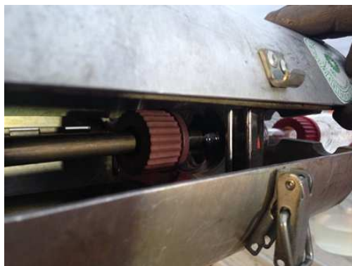
Meetopstelling (E01-A); dioxine bemonstering; quartz filter/filterhouder in verwarmde hotbox.
