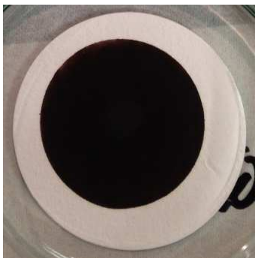
Filter(belading) E01-A, 6 uurs-meting, 27 januari 2016; zwart gekleurde belading belading (door SGS, ter indicatie, de massa belading berekend op ca. 2,96 mg/Nm 3 )
