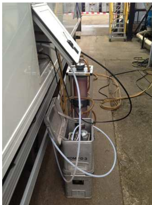
Meetwagen SGS; Isokinetische dioxine bemonstering; aanzuigpomp en (silica)droogtoren.
