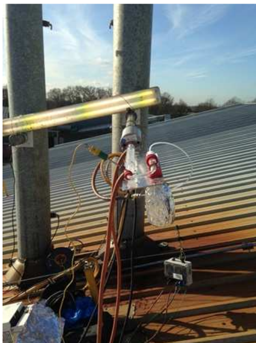
Meetopstelling E01-B; dioxine bemonstering (isokinetisch); filter/condensatie-methode; verwarmde probe/stoffilter (hotbox) gecombineerd S-pitot 1500mm ( f=0.803 )
