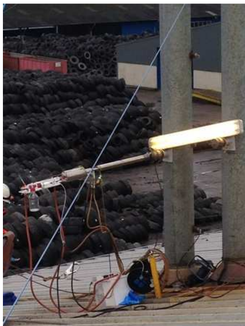
Meetopstelling E01-A; dioxine bemonstering (isokinetisch); filter/condensatie-methode; verwarmde probe/stoffilter (hotbox) gecombineerd S-pitot 1500mm ( f=0.803 )
