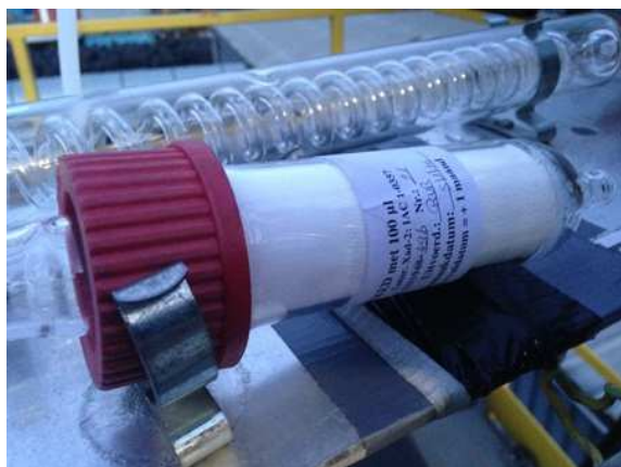
Meetopstelling E04; dioxine bemonstering; gekoelde spiraalkoeler / XAD-2 cartridge.
