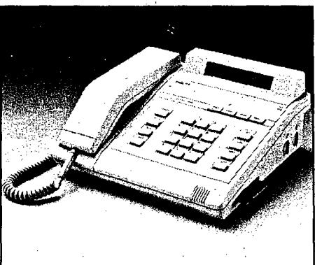
▲ De crypto-telefoon ofwel een telefoon met versciferapparaat voor het voeren van strikt vertrouwelijke gesprekken. Het apparaat is pas in crypto te gebruiken na invoering van de smart card en nadat een pincode is ingesteld
